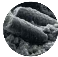
樹脂中のガラス繊維(顕微鏡写真) 樹脂の特性を損なうことなく、なおかつ高い塗膜強度を持たせるため、樹脂と均一になじむようにガラス繊維の形状や特性が調整されている。これが当社独自の特許技術の礎となっている。
