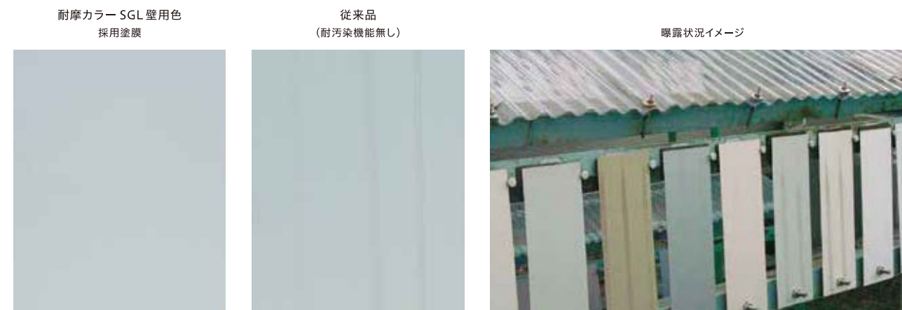
耐汚染機能の有無を比較した写真。右の写真には雨筋汚れがついている
