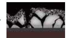
アルミ系酸化物生成物が充填される前に犠牲防食作用が働かなくなり、腐食が進行してしまう。
