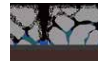
緻密な保護皮膜を形成し、亜鉛リッチ相の消耗を抑える。
