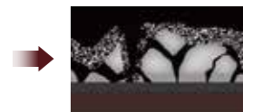
アルミ系酸化生成物が充填される前に犠牲防食作用が働かなくなり、腐食が進行してしまう。
