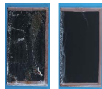
従来仕様品 エスジーエル塗装鋼板 * JIS H 8502 500サイクル (写真左が端部)
